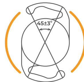
Имитация угла контакта гаптики с капсульным мешком (диаметр 10 мм) - 45\pm 3^\circ
